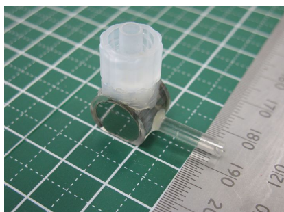
図1. 解析に用いた flow-cell タイプ平行板コンデンサー型測定セル。内容量は 0.39 ml である。
