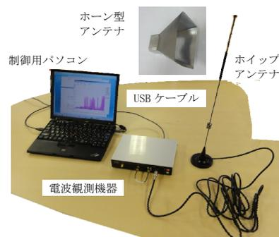
図 3 電波観測実験の機器構成
