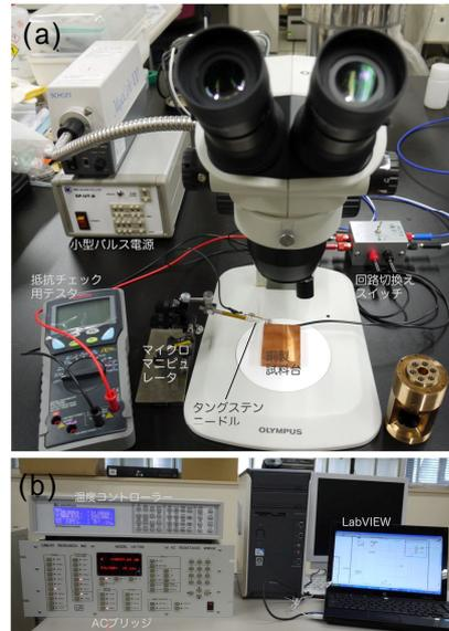
図6 (a)微小試料4端子形成システム。(b)低温高圧力下電気抵抗自動計測システム。
