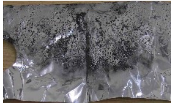
図 10 与圧室内壁に置かれたアルミシートに堆積した、黒いすす試料の写真。
