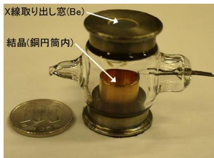
図3 高真空封入式小型X線発生装置の試作品
