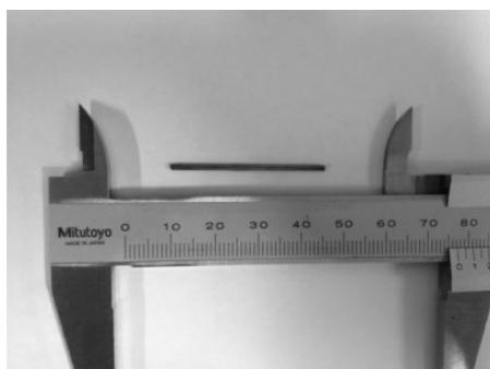
図2. Ti-Ni-Zr 高温形状記憶合金鑄造材
