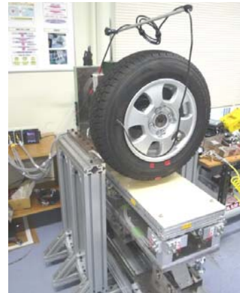
図10 路面摩擦係数測定実験
