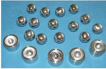
図2 人工股関節モデル試験片
