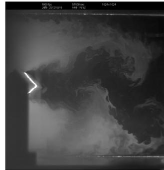
図7 角柱後流の渦の可視化写真
