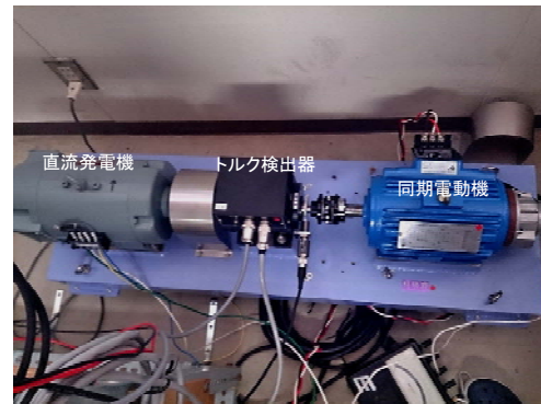
図 16 購入した電動機負荷装置
