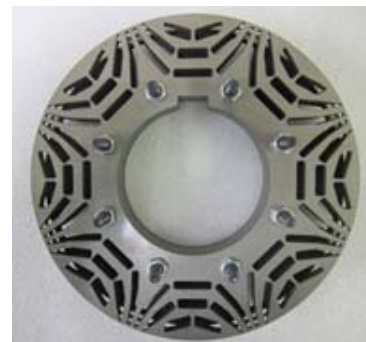
図 12 試作立体ギャップモデルのロータ
