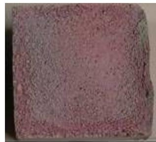
写真2 凍結融解を受けたモルタルの劣化状況(金属用浸透探傷剤を浸透させた供試体)
