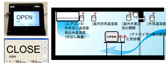
図1 窓開閉アドバイザーの構成と測定項目
