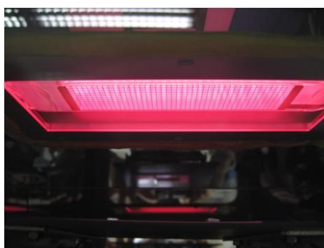
図 9 CNT シートへのエキシマランプ照射
