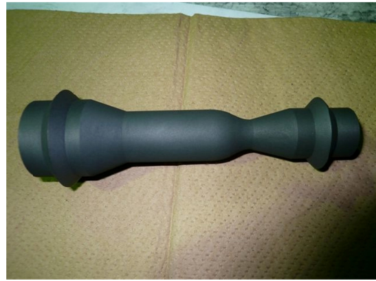
図5 小型スラスタ織物製作に使用した黒鉛製の分割型治具
