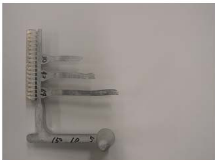
図 15 AZ91D 流動長実験結果の一例
