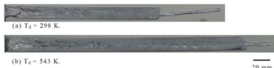
図 6 金型温度の影響 (流路肉厚 2.3mm, 溶湯過熱度 100K, 吸引圧力 40kPa)
