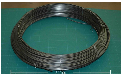
図3 多方向圧延によって製造されたオーステナイト線材
