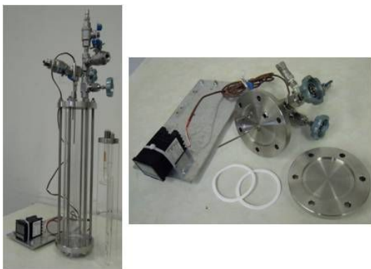
図3 動粘度測定用の圧力セル写真
