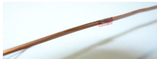
図5 銅線に取り付けたひずみゲージ
