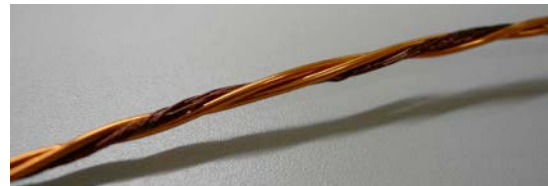
図4 一次撚線 (マンガン線 1 と銅線 2)
