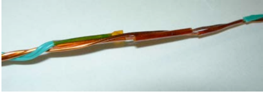
図6 一次撚線（ひずみゲージリード線1と銅線2）
