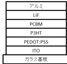
(a) 平板インプリントデバイスの構造
