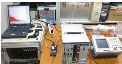
図 4 ゲルマニウム検出器測定システム
