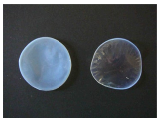
図 3 . 得られたフィルムの写真。左: (TEOS:エタノール:水) = (1:4:2) mol、右: (1:4:10) mol の処理条件。24 時間浸漬後に乾燥。
