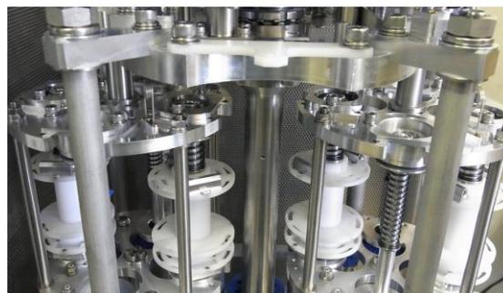
図2 衛星運動型HSCCC装置回転機構
