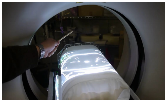
図 12 ファントムを用いたプロジェクションマッピングの様子
