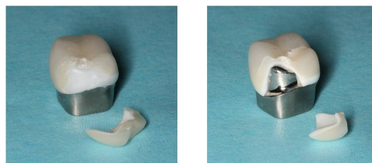
図 7 破壊試験後のクラウン試料
