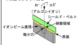
採取した試料は、固定、脱水、エポキシ樹脂包埋後、トリミングし、イオンスライサを用いて研磨、走査電子顕微鏡観察試料を作製した。
