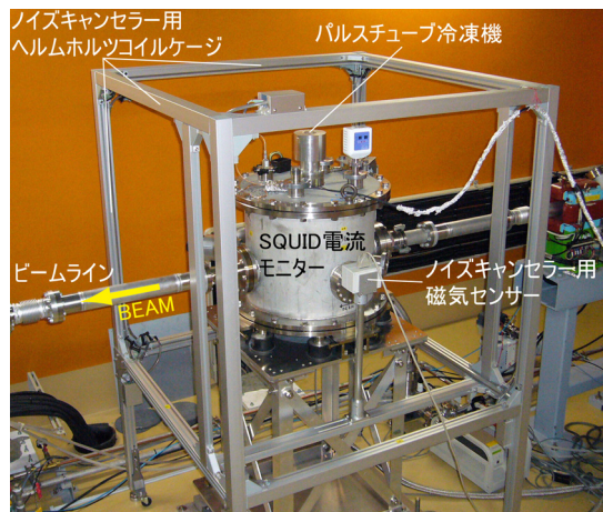
図 3 ビームトランスポートにインストールした SQUID ビーム電流計の写真。
