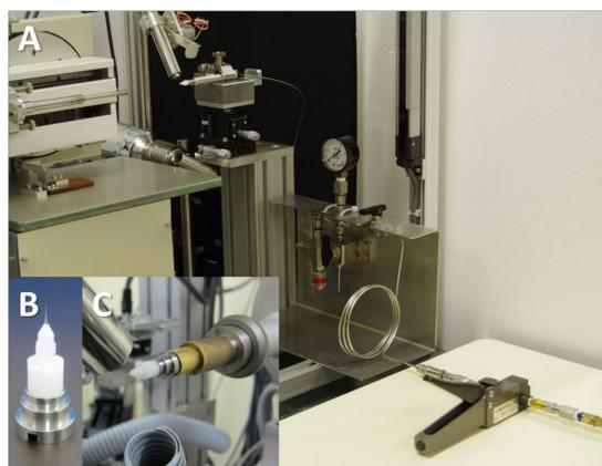
図2: ガス加圧装置。A: 装置全体像、B: ねじ付SPACE用試料ピン、C: 放射光実験時の様子。
