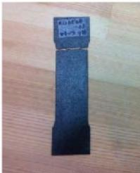
引張試験後試験片状況
