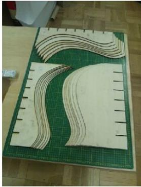
レーザーカッターにより切り出された木製合板
