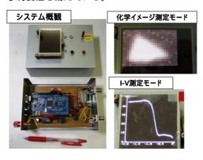
さらに測定システムの評価も行った。pH4,5,…,8のpH標準液の交流光電流 バイアス電圧特性(I-V特性)を取得し、I-V特性曲線の変曲点電圧のプロットから,pH 感度51.4mV/pH で pH 変化を検出可能であることを確認した。この値を用いることで pH 未知の溶液を測定することができる。
