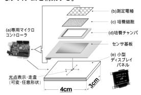
センサ表面の改質・測定電極・培養チャン バの形状、培養環境を維持しながら測定を行 う機構などの技術課題を、これまでの細胞を 用いたバイオセンシング研究で培った成果 および、研究分担者との協調によって解決し、 細胞層の透過率分布の可視化を行う。細胞群 のタイトジャンクションの変化によって、細 胞層の透過率分布が変化する様を観察でき る手法を確立する。
