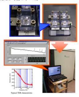
さらに、上記システムを改良し、同時に 4 検体を測定できるように拡張した。抵抗値測 定のみであれば最大4検体、位相遅延・進み まで含めた電気特性では最大2検体を各周波 数で測定することができる。この系を用いた 測定から、通常の化学イメージセンサ測定よ りも低い周波数で光源を変調した方が電気 特性の差違がはっきりと観測される可能性 が示唆された。また、研究代表者の宮本が以 前から提案している位相モード測定も適用 可能である可能性が示された。さらに、測定 ウェルの設計やシールドボックスの構造な ど化学イメージセンサを用いた測定系の構 築に向けて様々なノウハウを蓄積すること ができた。以上の成果について学会講演(う ち1件は招待講演)を通じて報告した。
