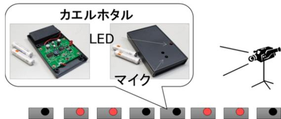
装置である。本装置を使用し，隠岐の島の田んぼで2年続けてカエルの合唱の観測を行い，画像処理の工夫を行い，田んぼの畦道で同期してカエルが鳴く現象(合唱)を可視化した。下記にその映像を示す。
