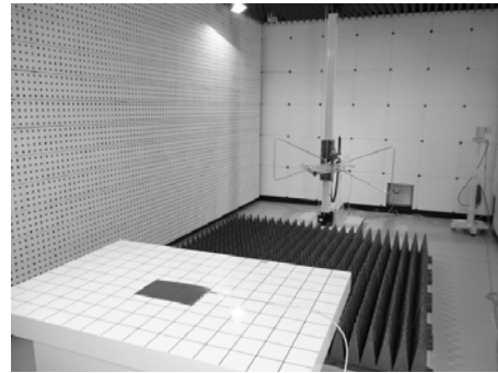
図 1 3 電波暗室による電磁ノイズ測定
