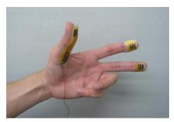
皮膚に作用する複合的な荷重環境においても、接触圧力に依存せずせん断応力を独立してかつ的確に測定できることを確認した。これにより、指の腹に直接接着が可能で、指が提示機構から受ける接触圧力と2方向せん断応力の合計3方向の接触応力を同時に測定可能なセンサを実現した。さらに、フォトリソグラフィー技術によって測定ユニットの微細高集積化を図り、親指に作用する圧力と2方向せん断応力を20箇所で分布として捉えることができるセンサを作製した。
