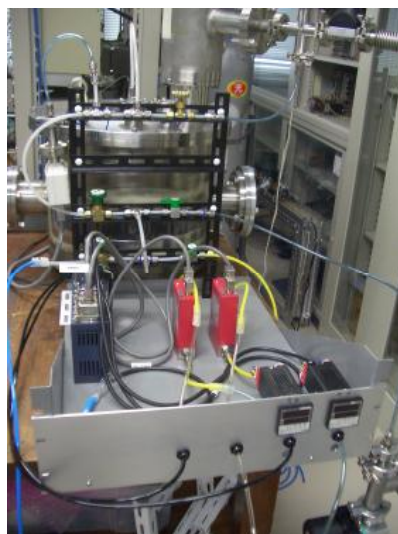
図 1 : ガス混合系。MFC と流量コントロールパネル、電源からなる。
