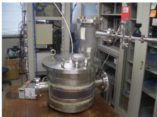
図3：真空箱。この中に冷却ブロックが入っている。右上の円柱状のものは液体窒素リザーバー、手前のマイラーを接着した横長のスリットが観測用窓、真空箱両側のダクトとフランジが光電子増倍管用のフランジ構造。
