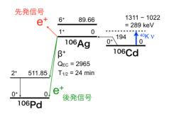
カリウム地球ニュートリノの測定に使用することができる原子核には 40 以上の候補があるが、この中でも比較的反応断面積の大きい ³He や ¹ºワ Ag が有力であるとされてきたが、バックグラウンド量の削減が重大な課題であった。一方、¹º⁶Cd を用いた場合には、以下のような利点がある。
