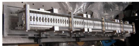
図2 試作した並進冷却装置
