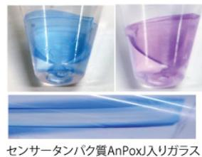
(6) ナノ細孔内に複合反応系を構築した。内部に無数の細孔をもつ、ホウ素珪酸ガラス板内にRu化合物と小分子メデエーター(DCIPやヴィオローゲン)、ヒドロゲナーゼ酵素タンパクを同時に導入した(Nojiら2014)。
