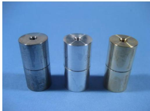
図3 各種金属接着試験片
