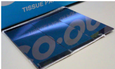
図5 フラッシュランプ照射によるSi研削ウエハの脆性破壊
