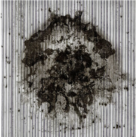
図 7 リング表面に形成された圧痕（印加電流：0.2 A、一辺の長さ：2.5 mm）
