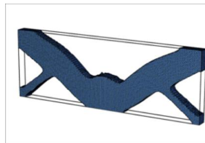
図7 トポロジー最適化により得られた荷重点で変位が最小となる構造
