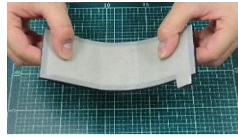
図17 3個の素子を分布配置したセンサ
