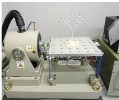
図3 小型加振機に設置された試験片
