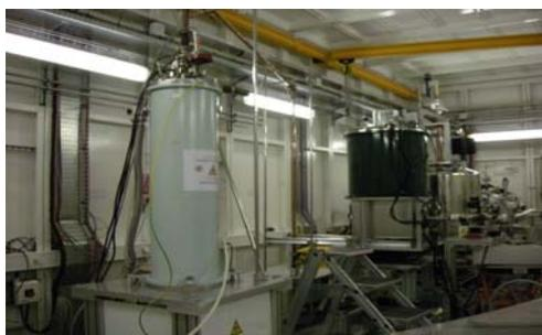
図 2 高出力光源-Gyrotron FU II (手前) と ESR 装置
