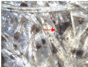
図-14 黒褐色点状の変状の実体顕微鏡観察(供試体 No.3C)
