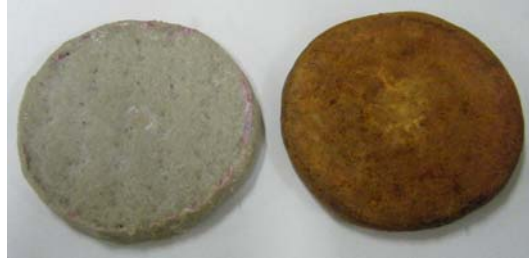
写真-1 透水試験終了後の GCL の様子 (左: Case 1, 右: Case 3)
