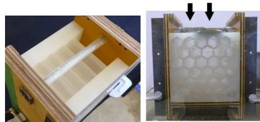
図2 流し込みによるハニカムパネルの試作
