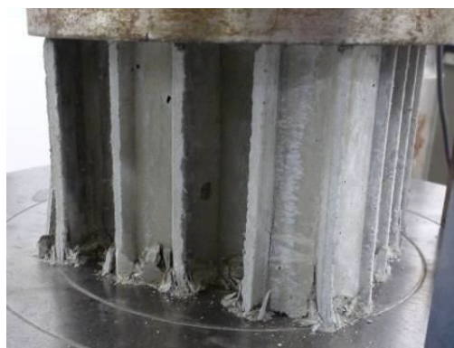
図5 載荷試験中のハニカムパネル(底面より座屈)
