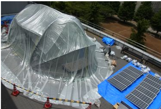
図 3:H24 年度負圧型インフレイブルモデル太陽電池で気圧差を作る試みも行った。
