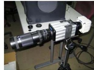
図4 高速度二色放射温度計測システム
