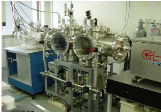
図 1 実験に用いたレーザーデトネーションイオンビーム装置
